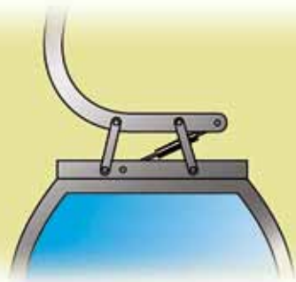
Раскачивание, амортизируемое гидравлическим демпфером
